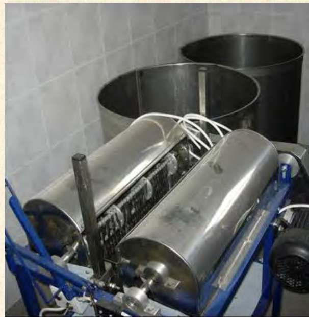
Slika 20. Mašina za otklapanje voštanih poklopčića
