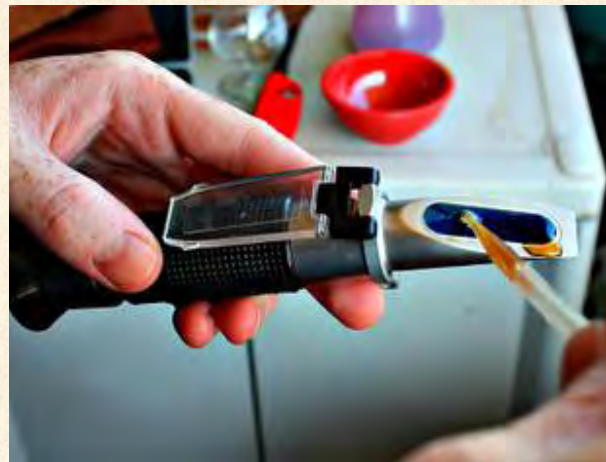
Slika 14. Refraktometrijsko određivanje vlažnosti u medu
